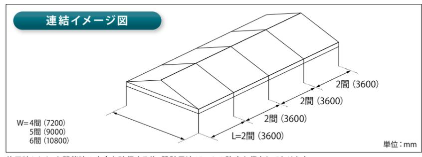
※別注対応: 上記以外のサイズも別注にて承ります。テントのサイズにより、アルミフレームの太さなどの規格が変わることがあります。
